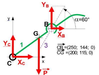
$$\text{et } \vec{M}_C(\vec{P}_1) = \vec{M}_C(\vec{P}_1) + \vec{CG} \wedge \vec{P}_1 = \begin{pmatrix} 0 \\ 0 \\ 0 \end{pmatrix} + \begin{pmatrix} 200 \\ 115 \\ 0 \end{pmatrix} \wedge \begin{pmatrix} 0 \\ 0 \\ -m \cdot g \end{pmatrix} = \begin{pmatrix} 0 \\ 0 \\ -200 \cdot m \cdot g \end{pmatrix}$$
