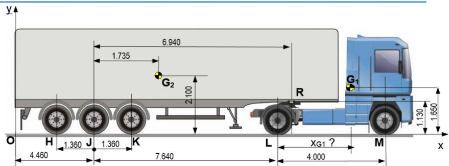
**Isoler (1)** et déterminer  $x_{G1}$ , la position du centre de gravité du tracteur (1) ainsi que l'action du sol en L.
