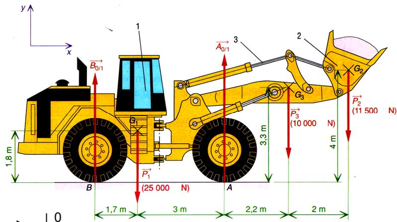
1) On isole le véhicule (V) :
