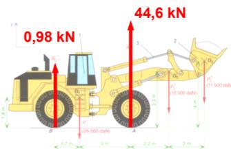
On remarque que la quasi-totalité du poids repose sur l'essieu avant ; l'essieu arrière est délesté par le moment des poids  $P_2$  et  $P_3$  qui ont tendance à faire basculer le tractopelle vers l'avant, dans un mouvement de rotation horaire autour du point A.
