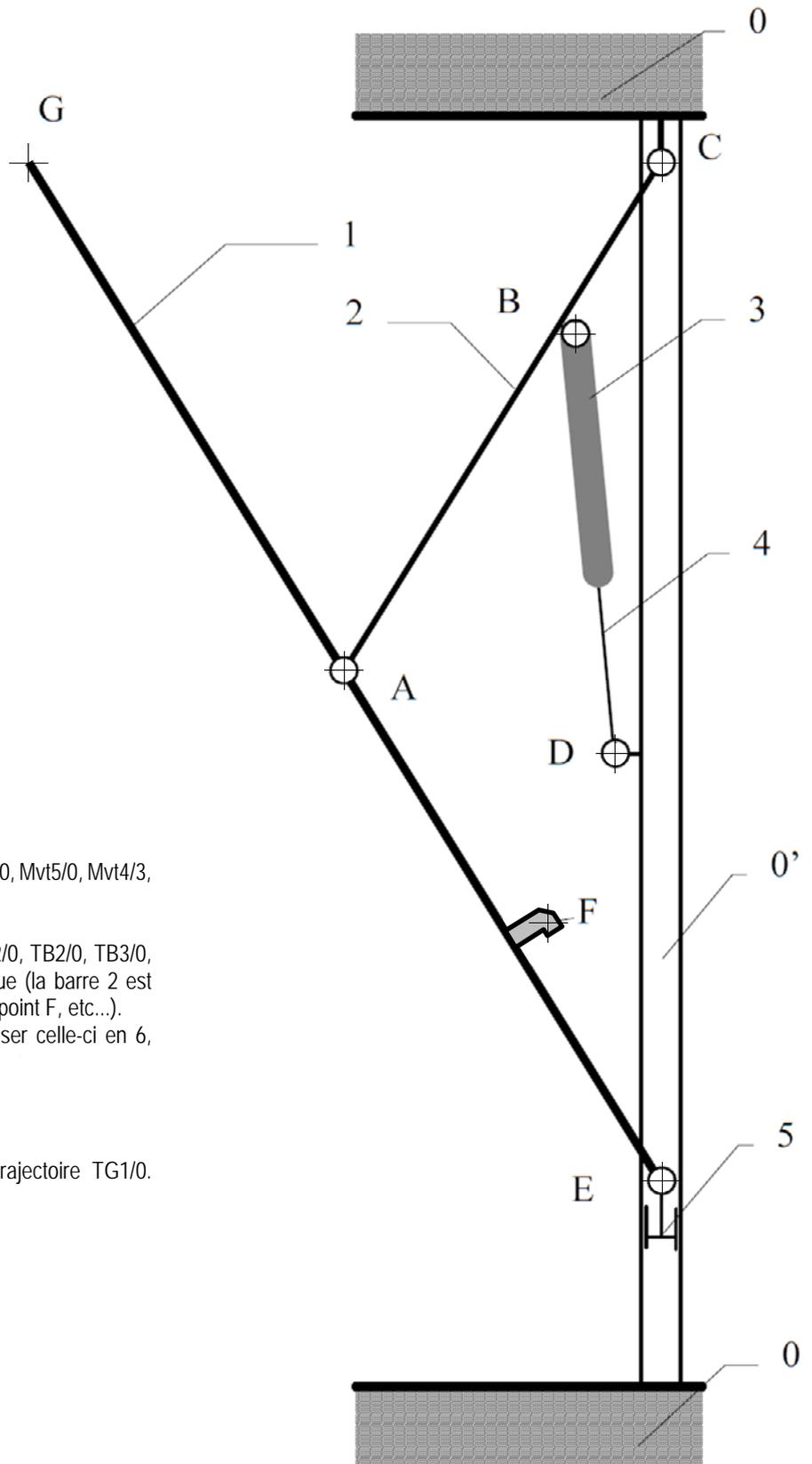
Q1) Quelle est la nature des mouvements suivants :  $Mvt2/0$ ,  $Mvt5/0$ ,  $Mvt4/3$ ,  $Mvt4/0$ ,  $Mvt1/5$ ,  $Mvt1/0$  ? Justifier dans chacun des cas.
