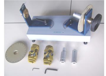
✎ Réaliser le montage des deux joints de cardan mis bout à bout de façon à ce que les fourches d'entrée des deux joints soient croisées à 90°, une clé 6 pans est fournie à cet effet. On pourra s'inspirer du dessin ci-dessous.
